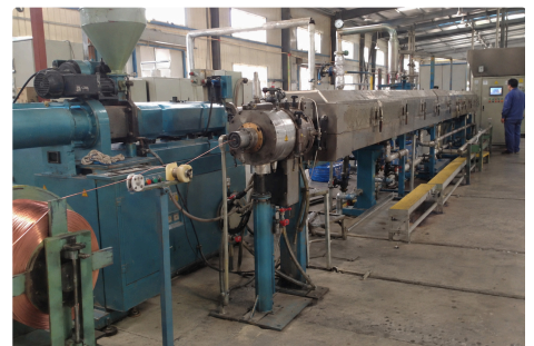
Extrusión y vulcanización continua del aislamiento.
