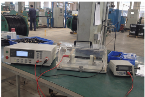
Pruebas de tensión aplicada y resistencia de aislamiento.
